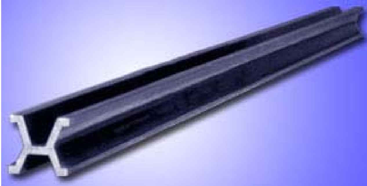
Pt-Ir Stange, zwei Linien in 1m Abstand eingraviert
